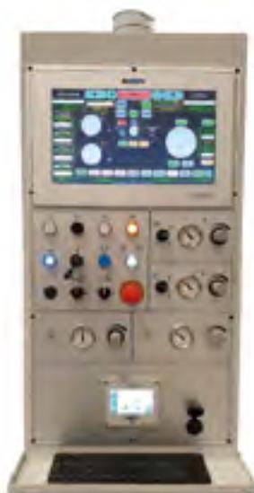
En outre, comme support pour la nouvelle console de commande, il est fourni un panneau à boutons poussoirs pour milieux industriels qui permet d'actionner toute la partie du dérouleur sans arbre. De cette façon, l'opérateur peut charger ou décharger les bobines mères, sans être lié aux commandes fixes classiques présents dans cette partie de la machine, en apportant une amélioration considérable en termes d'ergonomie, sécurité et rapidité.
